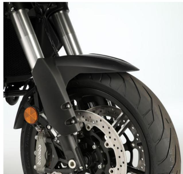
↑ **Suspensões Marzocchi** com forquilha invertida de 43 mm regulável no hidráulico e em extensão na dianteira, e monoamortecedor regulável na pre carga da mola no hidráulico e em extensão na traseira.
