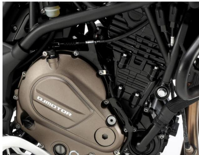
↑ **Motor bicilíndrico 698 cc, 8 válvulas** e refrigeração líquida, com uma potência de 54 kW (73,5 CV) e um binário máximo de 67 Nm às 6.000 rpm, incorporando um sistema de injeção eletrónica de combustível.
